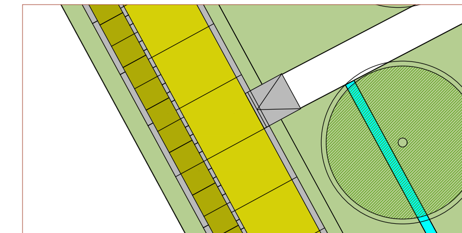
Principedetail haakse aansluiting bestaand pad op het circuit, zie bijlage voor tekening op schaal
